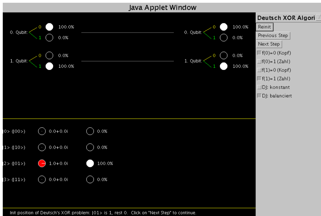
Abb. 9: Anfangszustand mit 0. Qubit auf 0 gesetzt, 1. Qubit auf 1 (d.h. Register ist im Basiszustand |01\rangle ). Oben sind die Zustände der Qubits gezeigt, unten die Amplituden der Basiszustände mit Visualisierung der Amplituden durch Vektor, Farbe und Helligkeit.
