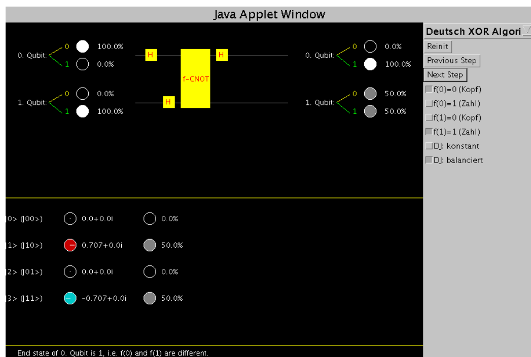
Abb. 12: Das Hadamard-Gatter hebt die Superposition des 0. Qubits wieder auf (Mischzustand wird zu Reinzustand) und führt zum Endzustand. Messung des 0. Qubits ist mit Sicherheit Zustand 1, d.h. die Münze ist echt, also f(0) \neq f(1) . Würde die Messung das 0. Qubits 0 ergeben, so wäre die Münze unecht, d.h. f(0) = f(1) .
